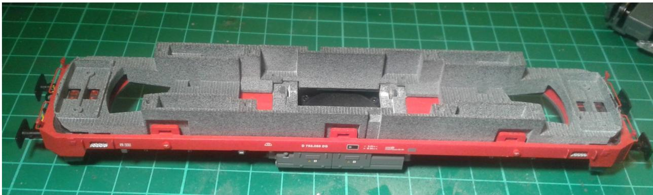
2 – Montare il motore senza le rondelle originali (l'orientamento è indifferente) fissandolo con le 4 viti lunghe 5 mm
